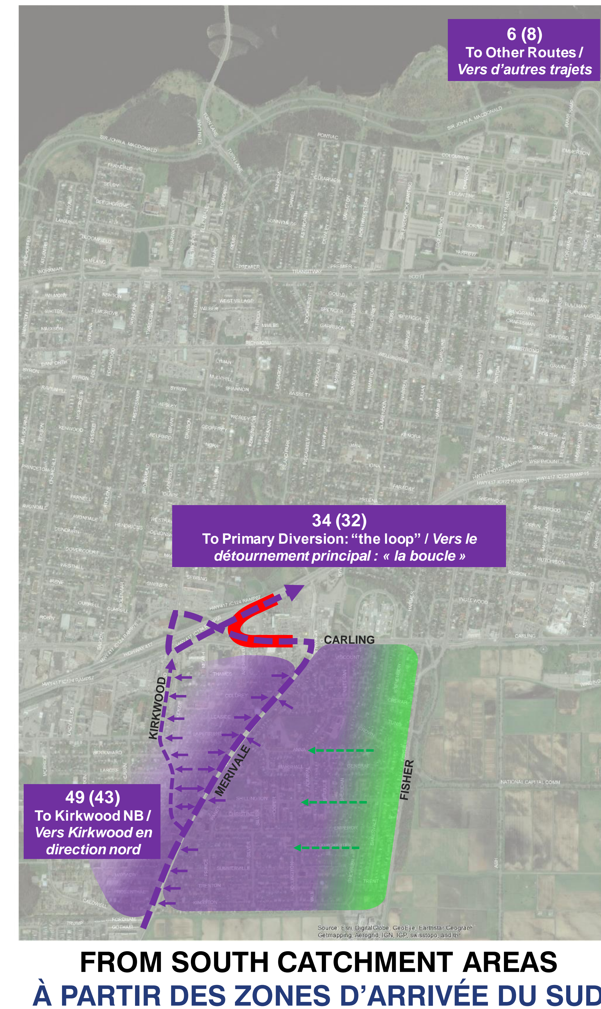
Redistribution with E-E On-ramp Closed (based on observed trip patterns and travel times) Redistribution avec la bretelle d'accès E-E fermée (basée sur les modes de déplacement observés et la durée des déplacements)
