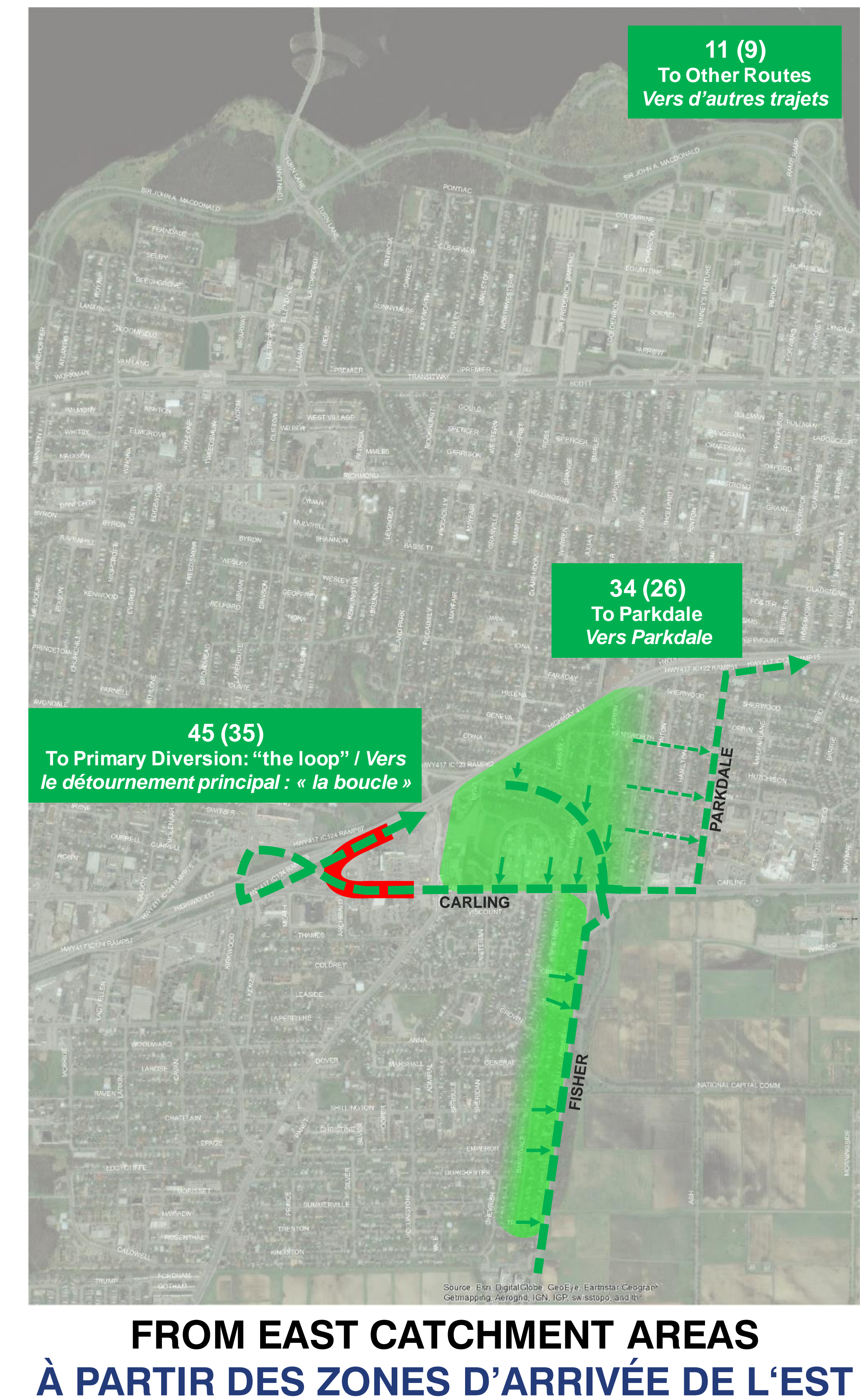
Redistribution with E-E On-ramp Closed (based on observed trip patterns and travel times) Redistribution avec la bretelle d'accès E-E fermée (basée sur les modes de déplacement observés et la durée des déplacements)
